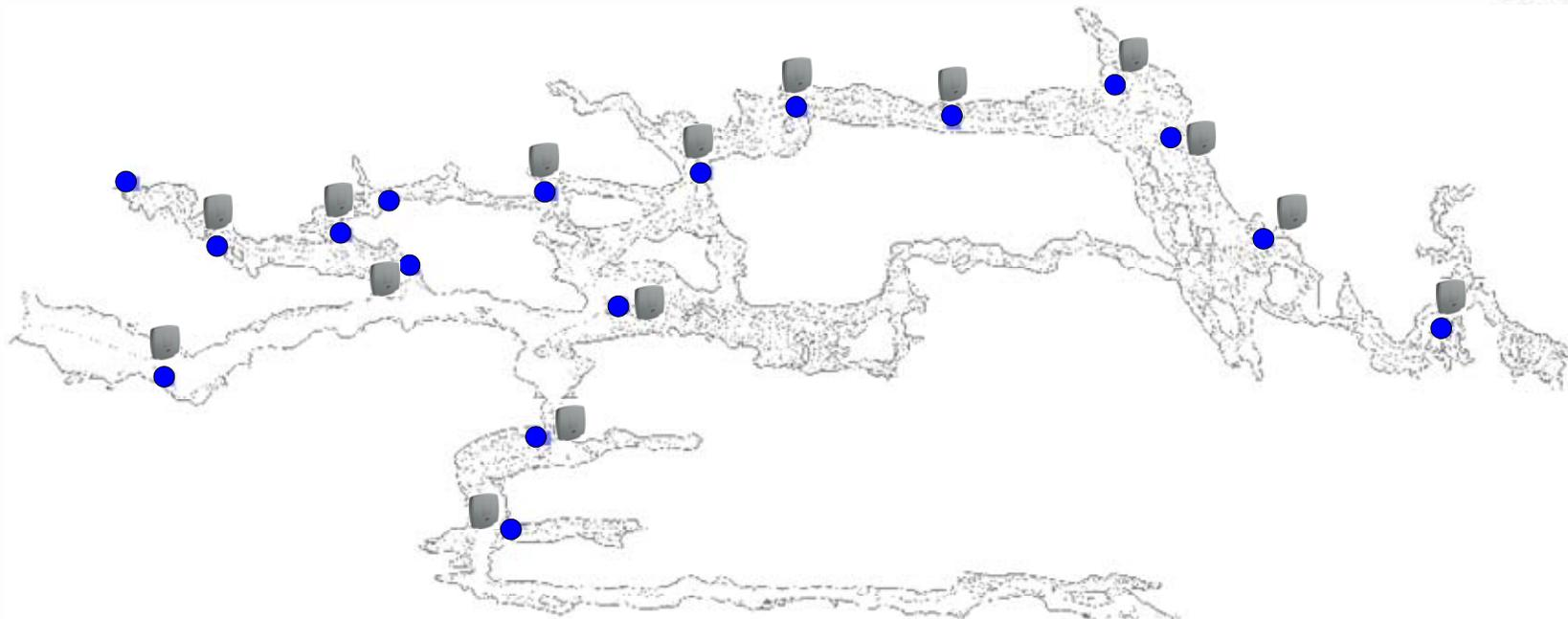
N° 20 Access Point CISCO 1242 per la copertura Wi-Fi
