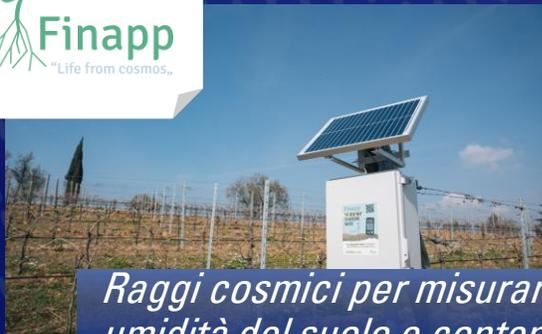
*Raggi cosmici per misurare umidità del suolo e contenuto d'acqua*
